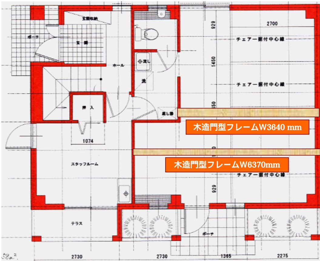
補強・偏心補正の為の2フレーム
